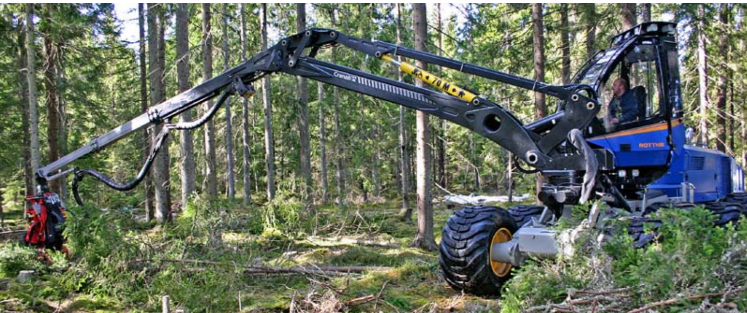
Leistungsstarke Kran mit Doppelteleskop und 11,3 Meter Reichweite
