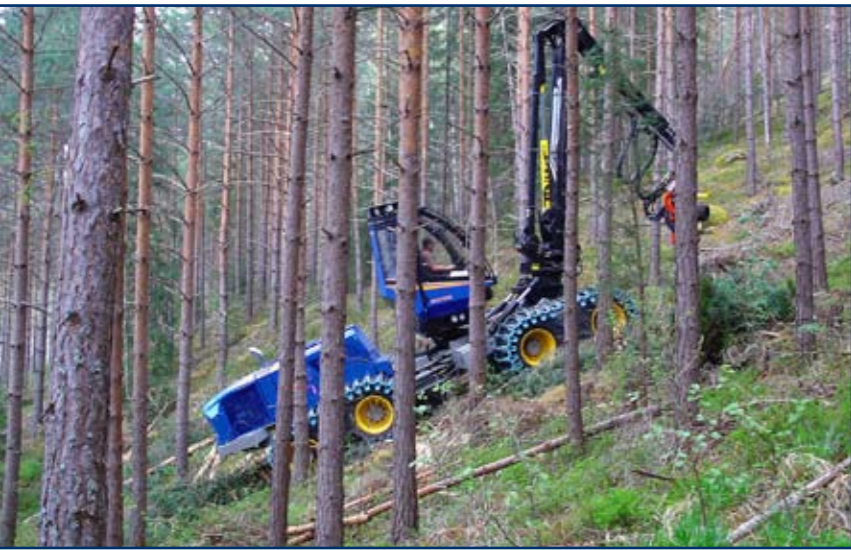
Optimal in steiliges Gelände mit Bänder vorn und hinten
